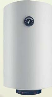
Murale ad accumulo di media capacità. Senza regolazione esterna della temperatura. Caldaia in acciaio smaltata. Anodo di magnesio per proteggere la caldaia dalla corrosione. Termometro. Isolamento in poliuretano.
